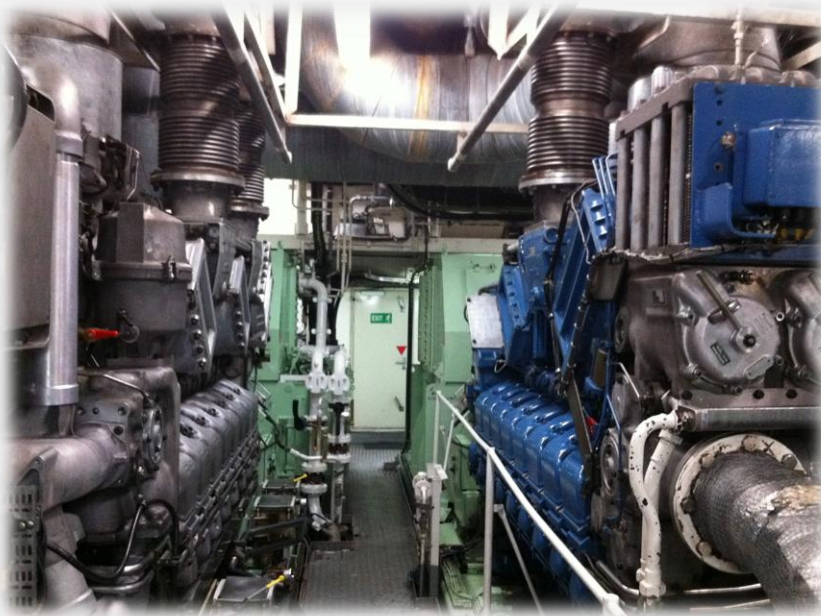
Unten der Maschinenraum mit den Generatoren, die den Strom für die Elektroantriebe produzieren usw.
